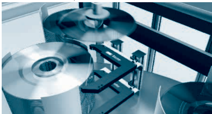
Contrôle de la hauteur de la pile de feuilles de CD
