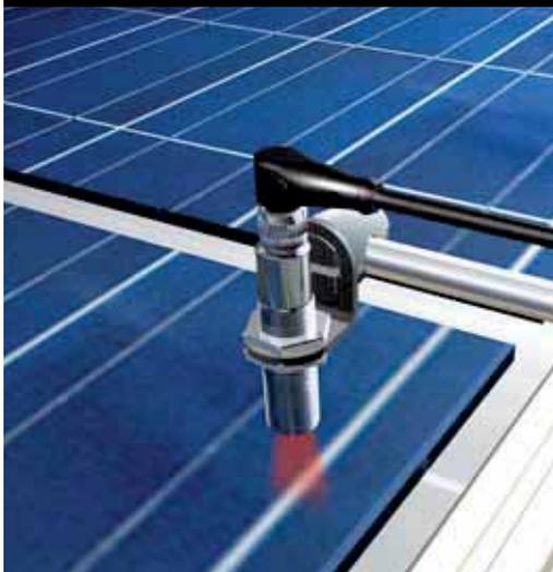
La détection de verre représente toujours un défi particulier pour les capteurs optoélectroniques. Bien souvent il n'est pas possible de monter un barrage optique à réflexion, si bien qu'une détection est uniquement possible au moyen d'un détecteur optique. Balluff propose ...
