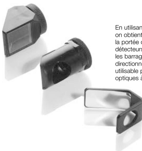
En utilisant le miroir angulaire, on obtient une réduction de la portée de 30 % pour les détecteurs optiques M12 et les barrages optiques monodirectionnels M12. Non utilisable pour les barrages optiques à réflexion.
