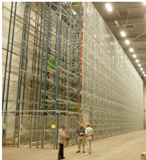
Axelent SafeStore avec des mailles de 50x60. Projet livré à Scania à Oskarshamn.
