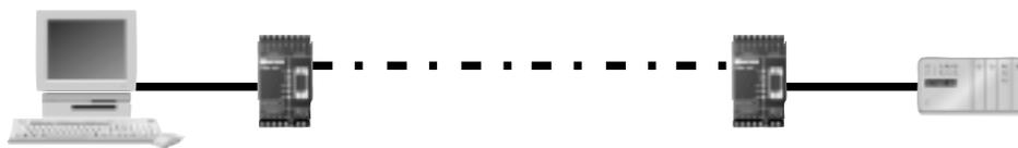
La connexion sur des lignes spécialisées ou louées peut être réalisée indifféremment en 2 fils ou 4 fils.
