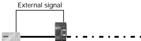
La numérotation d'un appel sortant peut être lancée lorsqu'un signal est appliqué sur la broche du signal DTR du connecteur RS-232/V.24. Une application classique est l'envoi d'une alarme par un automate ou bien par le contact d'un relais.
