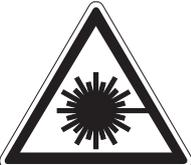
Le scrutateur laser de sécurité S 3000 renferme une source laser de classe 1. Des mesures complémentaires de protection concernant le faisceau laser ne sont pas nécessaires (aucun danger pour les yeux).
