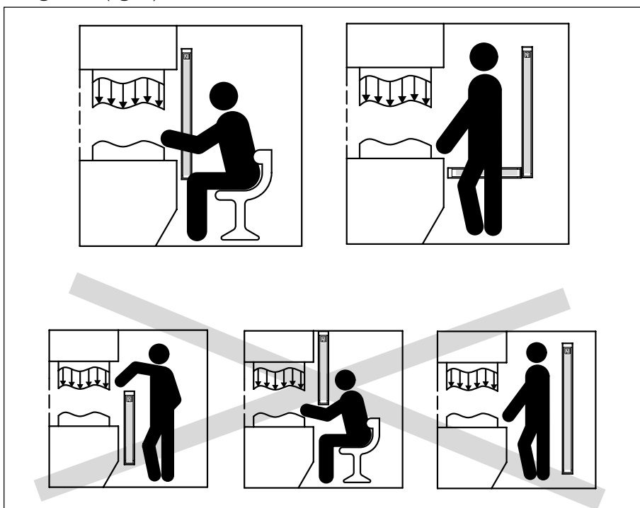
Fig. 2 : Pour le montage, il faut s'assurer qu'il n'est pas possible de passer (même un bras) par dessus, par dessous, par les côtés, par derrière.
