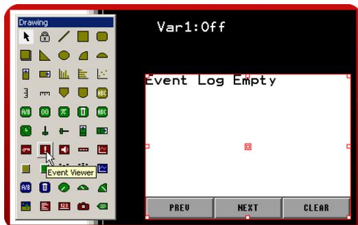
Lorsque la variable "Bit" passera à ON une alarme sera créée, elle sera affichée dans le "Visualisateur d'évènements" et sera enregistrée en CSV sur la carte CompactFlash.
