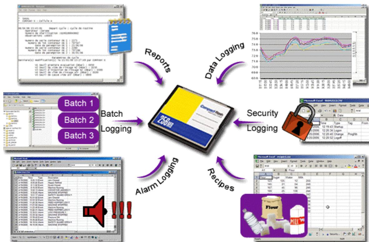
Non seulement la CompactFlash permet un stockage de données énorme pour les historiques de données et d'évènements mais elle fournit aussi un moyen de chargement d'une application sans PC.
