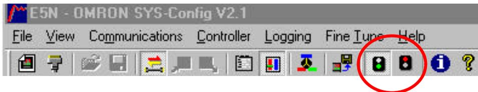
Cette fonction permet de mettre en marche la régulation . Lors de l'activation ou la désactivation de cette fonction, les leds "Stop", "Cmw" et "Out" s'enclenchent simultanément sur le régulateur et l'affichage PC .
