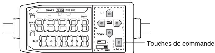
Le mode sélectionné détermine les fonctions des touches.
