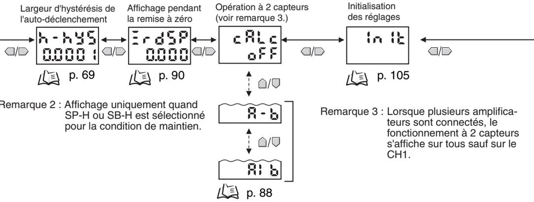
Lorsque cLOSE est sélectionné, les fonctions spéciales ne s'affichent pas et l'affichage revient à InU
