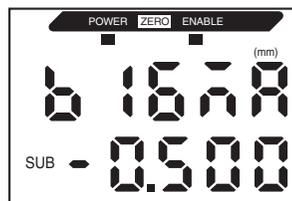
Confirmation de l'exécution du paramétrage de la mise au point
