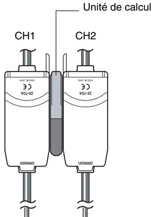
Le résultat du calcul s'affiche sur (c'est-à-dire est envoyé à) l'amplificateur CH2. Branchez le câble de sortie du CH2 sur le périphérique externe pour activer le contrôle externe.
