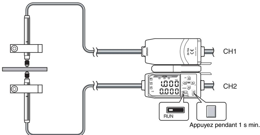
La relation entre les positions des têtes de capteur CH1 et CH2 sera enregistrée selon le même timing que celui utilisé lors de l'exécution de la remise à zéro. (La valeur d'affichage ici est 1 mm.) L'épaisseur est mesurée en fonction de la relation des têtes de capteur, le résultat de la mesure s'affiche sur l'amplificateur CH2.
