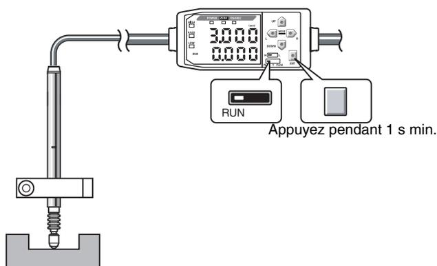
La position de la tête de capteur sera enregistrée selon le même timing que celui utilisé lors de l'exécution de la remise à zéro. (La valeur affichée ici est 3 mm.) La mesure de la profondeur se base sur la relation de position de la tête de capteur.
