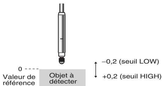
Exemple 2 : Mesure des différences de hauteur sur les objets à détecter (remise à zéro à chaque mesure)
