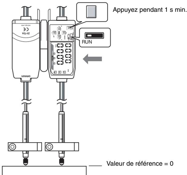
L'état sans différence de hauteur (0) sera enregistré selon le même timing que celui utilisé lors de l'exécution de la remise à zéro. Maintenant, l'amplificateur CH2 affiche des différences de hauteur entre les points de détection.
