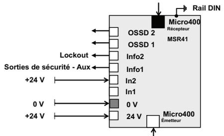
Figure 3 : Module de base MSR41, barrière photoélectrique Micro 400, réinitialisation auto, aucun contrôle en sortie
