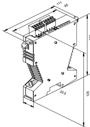
Figure 2 : Le module de base et les modules d'expansion ont les mêmes dimensions.
