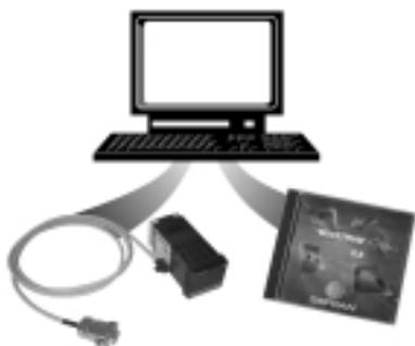
**N.B.** L'interface RS232 pour la configuration par PC est fournie avec le logiciel de programmation WINSTRUM. Le raccordement doit être effectué avec l'appareil sous tension et les entrées et sorties non raccordées.
