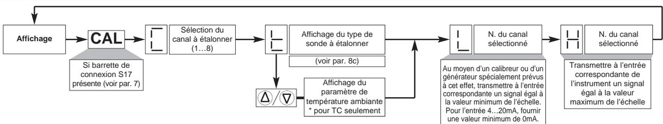
**ATTENTION:** L'instrument est livré étalonné; son éventuel étalonnage sur le terrain doit être effectué par un Technicien qualifié et équipé des appareillages nécessaires. Cette opération est irréversible.
