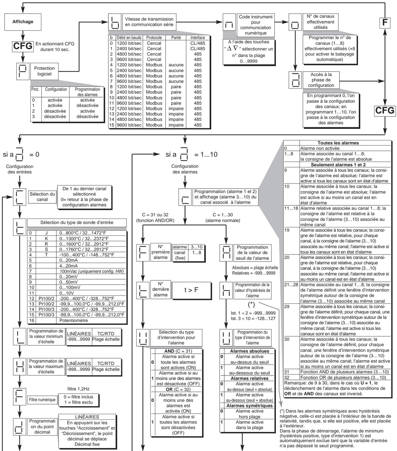
Le passage entre les différentes phases de configuration s'effectue à l'aide de la touche CFG; l'actionnement de la touche F permet toujours de rétablir l'affichage
