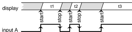
**MODE In-AB** START sur le flanc positif de A.
