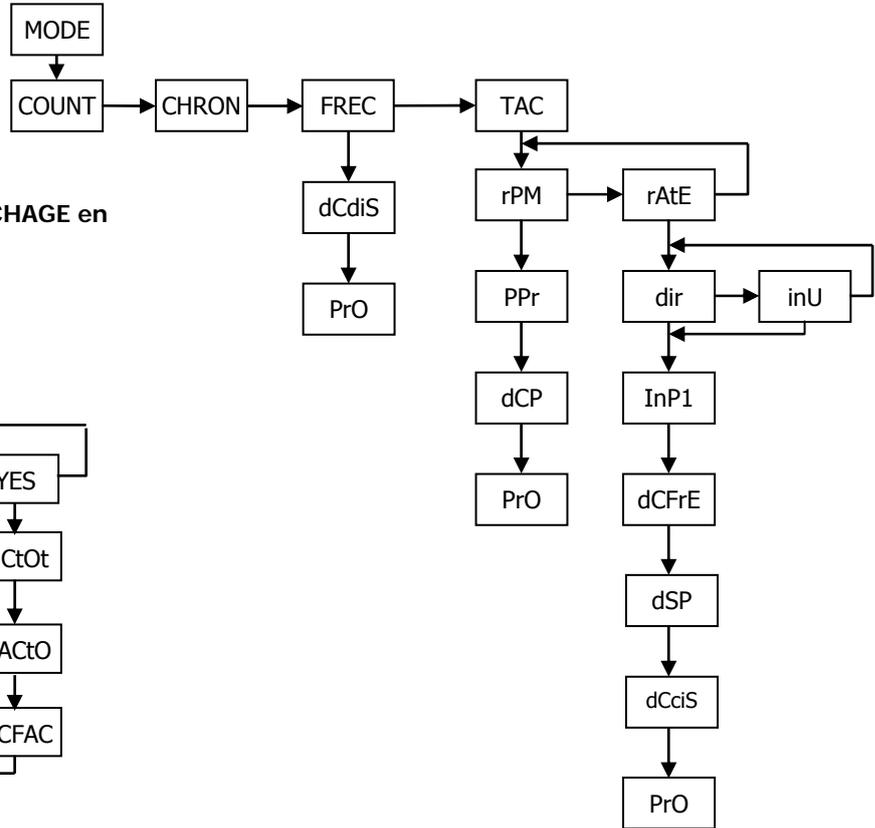
**Diagramme de programmation de L’AFFICHAGE en mode: FRÉQUENCEMÈTRE/ TACHYMÈTRE**
