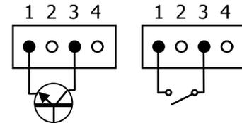
L'électronique extérieure qui s'applique aux entrées du connecteur CN3 doit être capable de supporter un potentiel de 40V/20mA à tous les pins relatifs au COMMUN. Pour garantir la compatibilité électromagnétique il faut prendre en compte les recommandations de connexion de la page 9.
