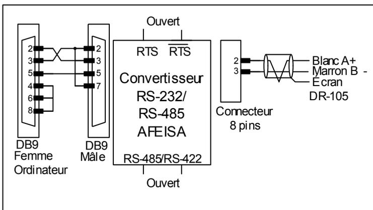
Le type de connecteur (mâle ou femelle) correspond à celui dont le câble doit être doté.
