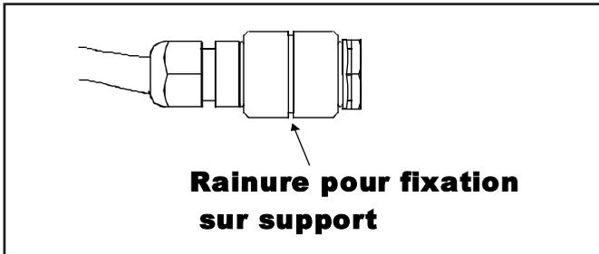
Un support de type clip est fourni pour fixer la sonde. Pour ouvrir ce dernier, introduire un tournevis plat dans la rainure marquée « Open » et exercer une légère pression vers l'extérieur, puis tirer vers le haut. Le support étant fixé, disposer la sonde dans le clip de manière à ce que la rainure de la sonde coïncide avec le bord du clip. Fermer le clip. La sonde est installée.
