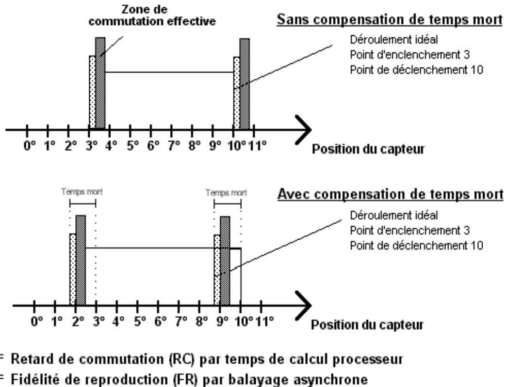
Illustration 22: diagramme en fonction du temps - compensation du temps mort
