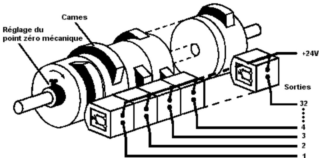
Illustration 1: dispositif de connexion à cames mécanique
