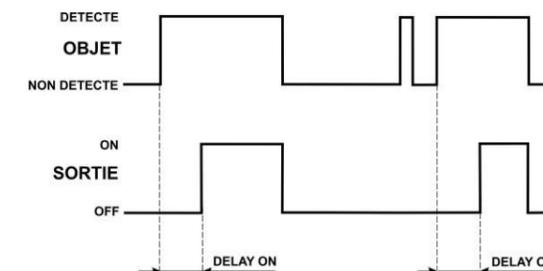
Pour sélectionner la fonction DELAY ON choisir l'option "dOn" au menu des paramètres. L'appui sur la touche blanche (SET) donne accès à la programmation du paramètre. L'afficheur présente la valeur de retard précédemment entrée.
