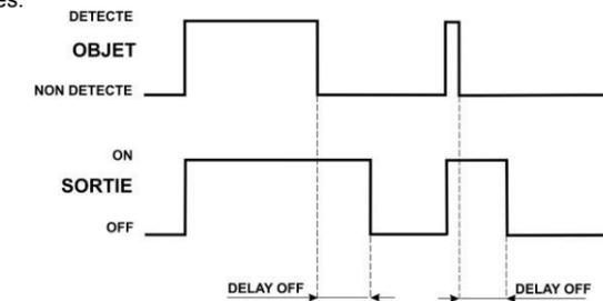
Pour sélectionner la fonction DELAY OFF choisir l'option "dIOF" au menu des paramètres. L'appui sur la touche (SET) donne accès à la programmation du paramètre. L'afficheur présente la valeur de retard précédemment entrée.
