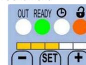
Au fur et à mesure qu'augmente ou diminue le seuil les LED de droite ou de gauche clignotent à une fréquence proportionnelle à l'écartement du seuil de départ.
