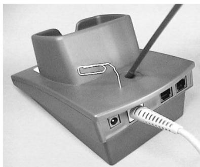
**Figure 5 – OM-DRAGON™ - Connexion/Déconnexion d'un câble**
