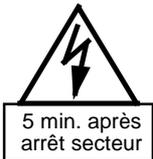
⇒ Attention ! Avant chaque intervention, isoler l'appareil du secteur et attendre au minimum 5 minutes jusqu'à ce que les condensateurs du circuit intermédiaire se soient déchargés à une tension résiduelle non dangereuse.
