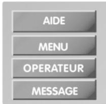
Pour indiquer clairement à l'opérateur le fonctionnement de la machine : données de production, messages d'Alarmes, messages de Défauts, Menu de modification des consignes, ... le terminal PCS met à votre disposition différents types de Message dont la priorité à l'affichage est gérée par le terminal lui-même.
