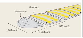
Coussin de ralentissement de haute qualité et ultra-résistant réalisé à partir d'un mélange de caoutchouc spécial. Convient aux utilisations durables extrêmes.
