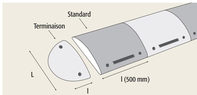
Ralentisseur à base de plastique recyclé. Garantit le respect de certaines vitesses. Pour les sorties, les zones de chargement, les balances, les passerelles, etc. Très visible grâce aux coloris jaune et noir. Des éléments de terminaison latéraux protègent les cyclistes et les piétons.
