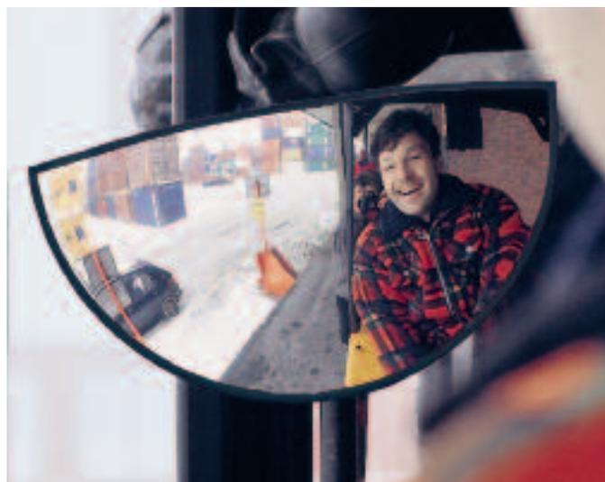
Rétroviseur de haute qualité à angle large pour chariots élévateurs (engins de manutention) et engins de chantier. En verre acrylique résistant aux chocs.
