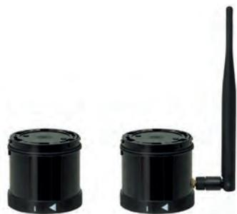
Le WIN transmitter transmet le statut de la machine vers le WIN receiver, qui copie le signal sur une colonne déportée.
