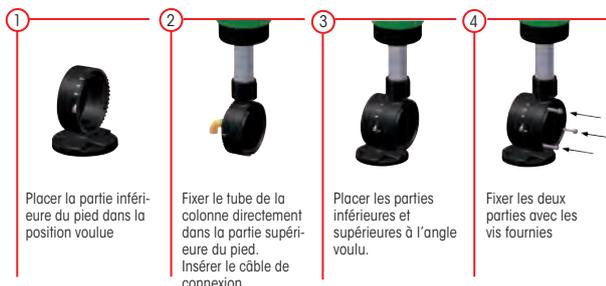
Pied pliable - La colonne peut être repliée, avec joint plastique, pour montage sur tube Ø 25 mm (non inclus)
