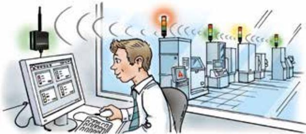
WERMA propose une solution simple et peu coûteuse pour une surveillance sans fil de machines d'âge et de fonctions différentes : le système WIN (Wireless Information Network). WIN est la combinaison idéale de la signalisation locale, de la technologie radio, et d'un logiciel simple et intuitif. L'interface commune à toutes les machines est la colonne lumineuse WERMA. Le système d'acquisition de données WIN est simple à mettre en service et peut être étendu à tout moment.
