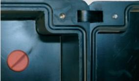
Épaisseur de paroi de 12 mm pour une robustesse maximale; fixation de la partie avant sur la partie arrière par vis situées en dehors de la zone d'étanchéité (classe 2).
