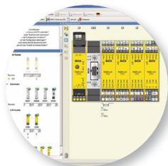
✓ **Maintenance rapide** : votre programme applicatif est sauvegardé dans le connecteur d'alimentation de votre station Flexisoft. L'échange d'un module ne nécessite pas de PC. Les temps d'arrêt sont donc réduits et vous gagnez en productivité.
