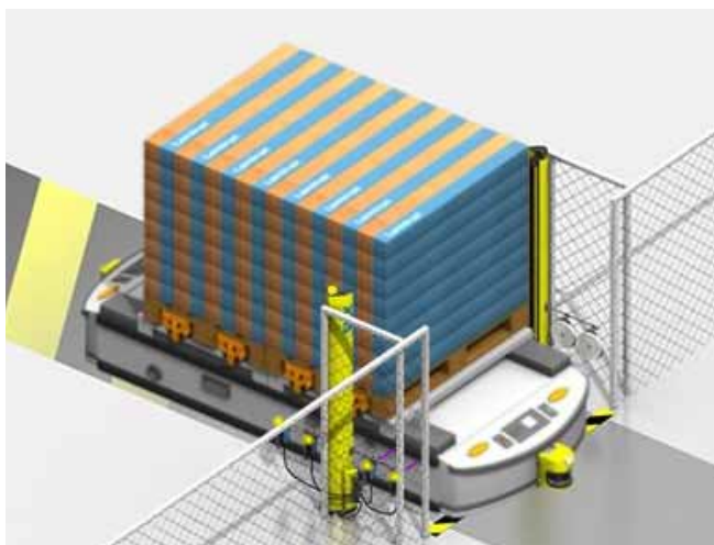
Station d'entrée/sortie avec 4 capteurs d'inhibition, déplacement des matériaux possible dans les deux directions
