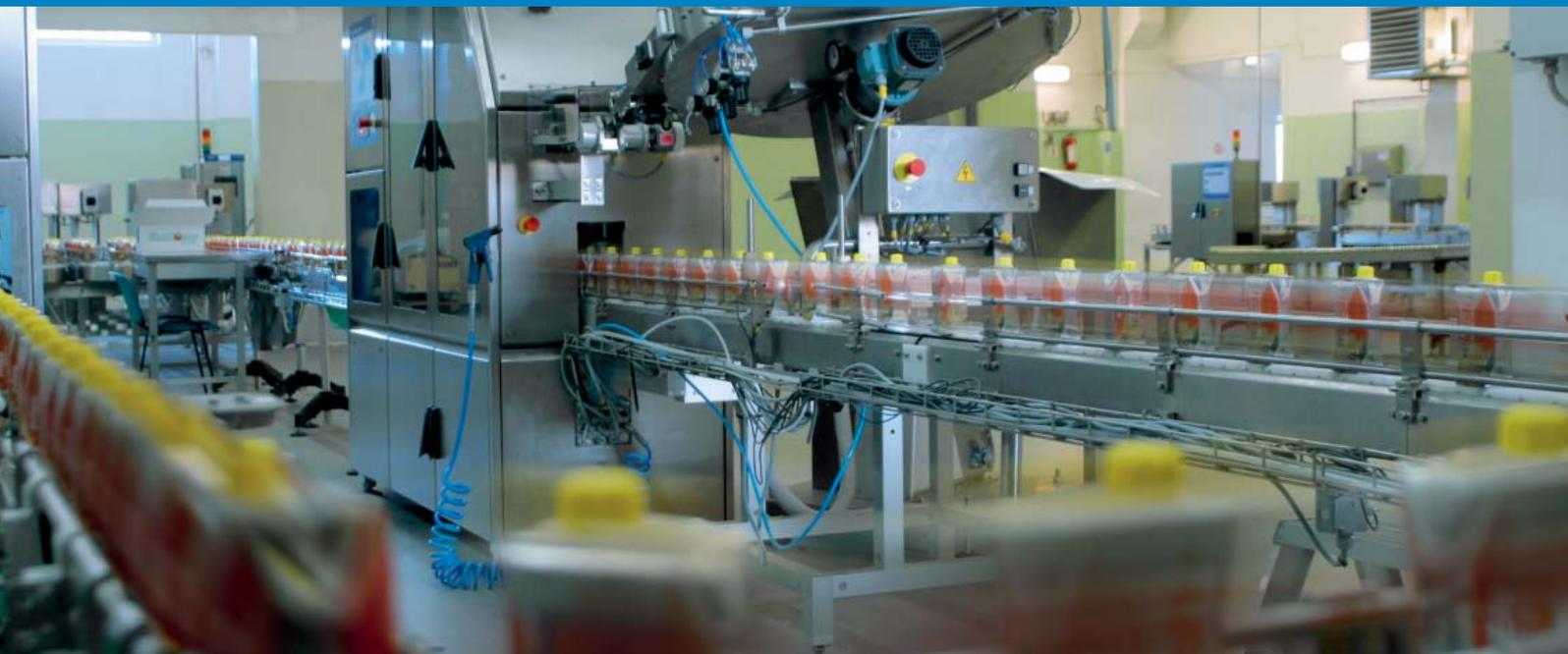
**Le capteur de vision Inspector examine les détails d'une pièce - contour, contraste et niveaux de gris - dans n'importe quelle position ou orientation.**
