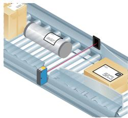
Détection de colis sur convoyeur
