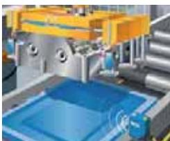
Détection de partie haute de bloc moteur
