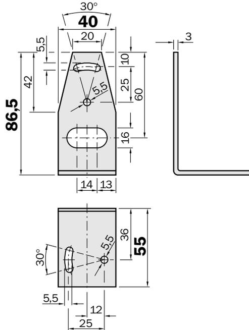
Fixation universelle (fixation sur barre ø 12 à 20 mm) pour capteurs et réflecteurs
