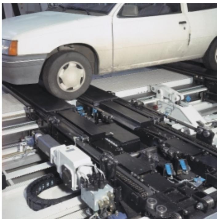
▲ Les détecteurs WT 27-2 positionnent un véhicule sur un plateau télescopique coulissant dans un parking automatique.
