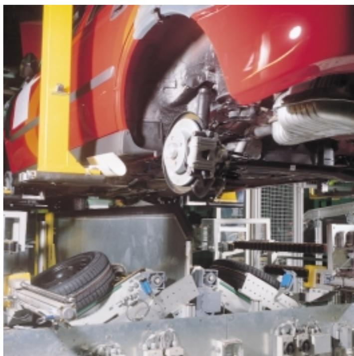
▲ A l'aide de détecteurs réflech WT 27-2, les pneus sont détectés et positionnés automatiquement avec précision avant le montage.
