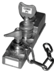
Loquet chaîne 20cm/30cm... réf: C0.2 / C0.3 Maillon diamètre 5 mm matière INOX
