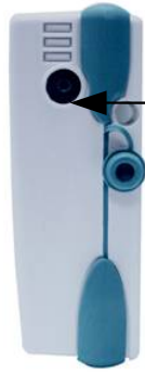
Connecteur type Jack 3,5 Entrée pour interface KISTOCK-PC
