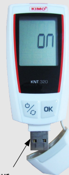
Adaptateur USB femelle / micro-USB mâle (référence KNT-A)
