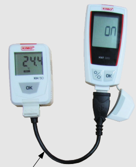
Adaptateur USB femelle / micro-USB mâle (référence KNT-A)
