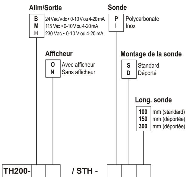
Exemple : TH200-BN/STH-PD300 est un capteur transmetteur d'humidité et de température de type TH200, alimentation 24 Vac/Vdc, sans afficheur, avec sonde en polycarbonate déportée de 300 mm.
