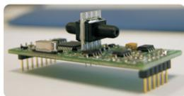
La carte SPI (Sonde de Pression Interchangeable) intègre un élément sensible de type piézorésistif ainsi que son électronique numérique. Ce système, ajusté individuellement, intègre tous les paramètres d'étalonnage. Automatiquement reconnu par le capteur cette carte numérique est totalement interchangeable. Elle facilite grandement la maintenance, le service et l'étalonnage des capteurs sans immobiliser l'ensemble de la chaîne de mesure lors d'interventions.
