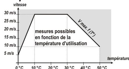
**Etendue de mesure** ..... 0 à 5m/s, 0 à 10m/s, 0 à 15m/s, 0 à 20m/s, 0 à 30m/s
