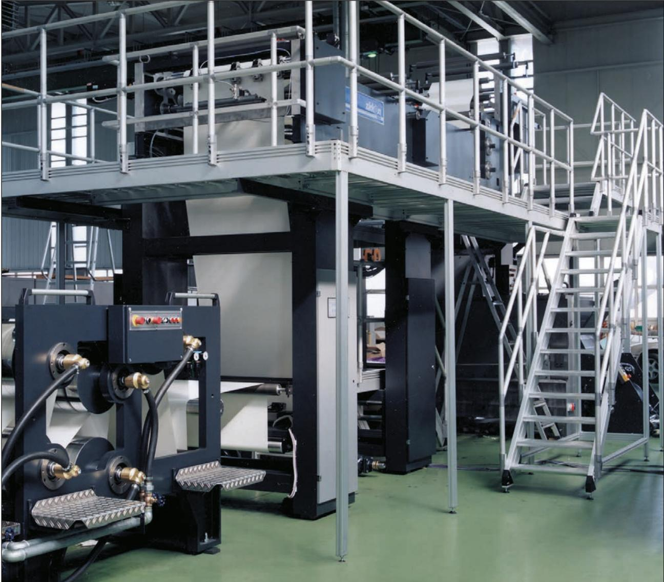
Plate-forme de travail avec escalier sur rotative offset.
