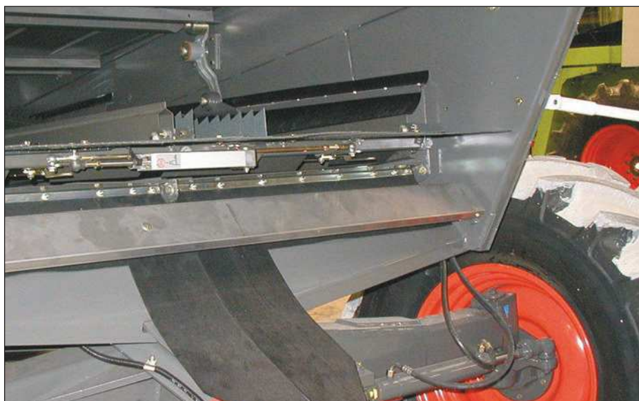
Réglage du tamis d'une moissonneuse-batteuse à l'aide de vérins électriques de la série 010. Utilisation dans des conditions extrêmes (chaleur, poussière et secousses).
