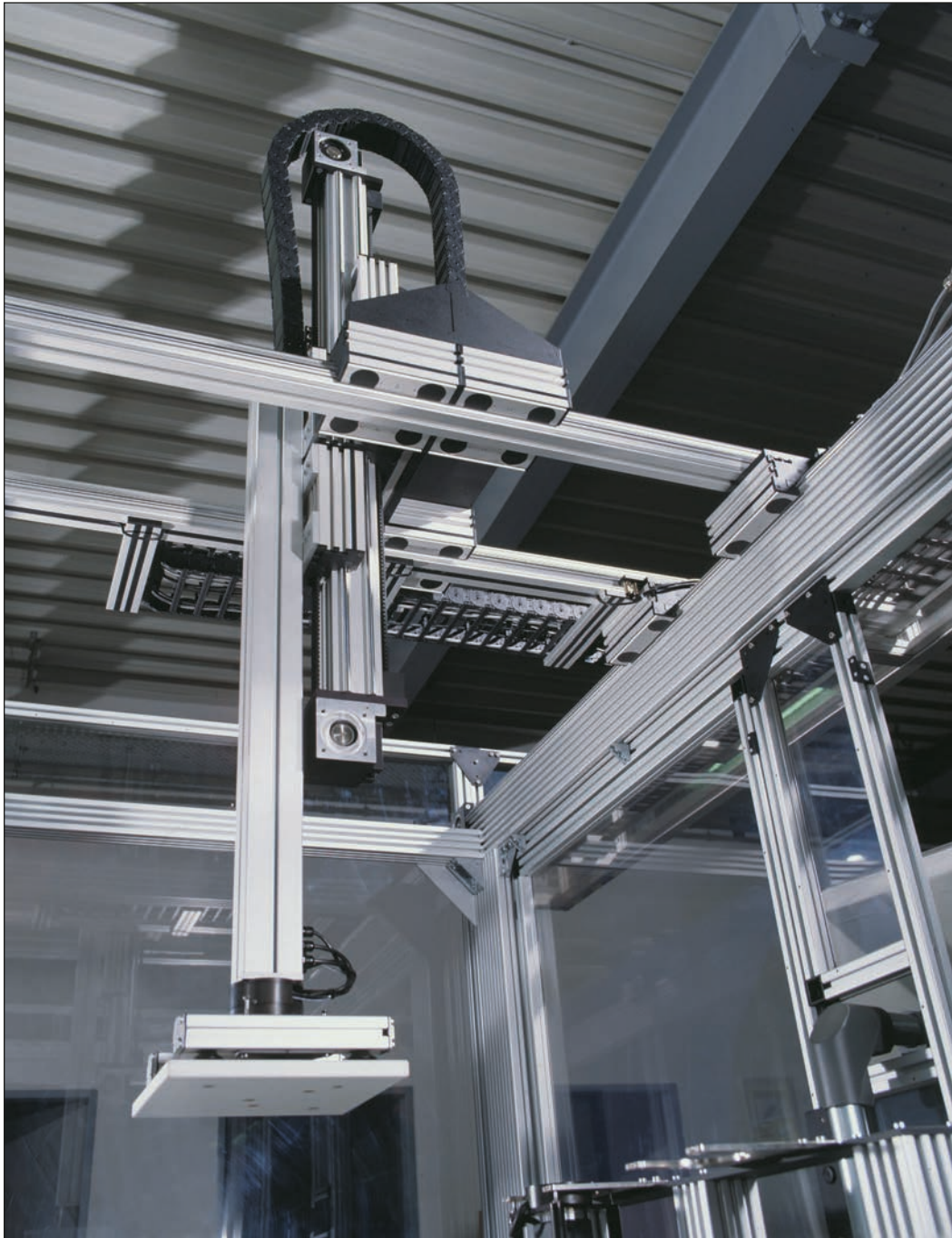
Système de portique à 3 axes d'un centre d'usinage
