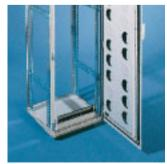
Système de guidage d'air L'air froid introduit par l'ouverture du fond est conduit à travers le socle et la double paroi de la porte pour une orientation ciblée sur les points chauds, voir page 23.
