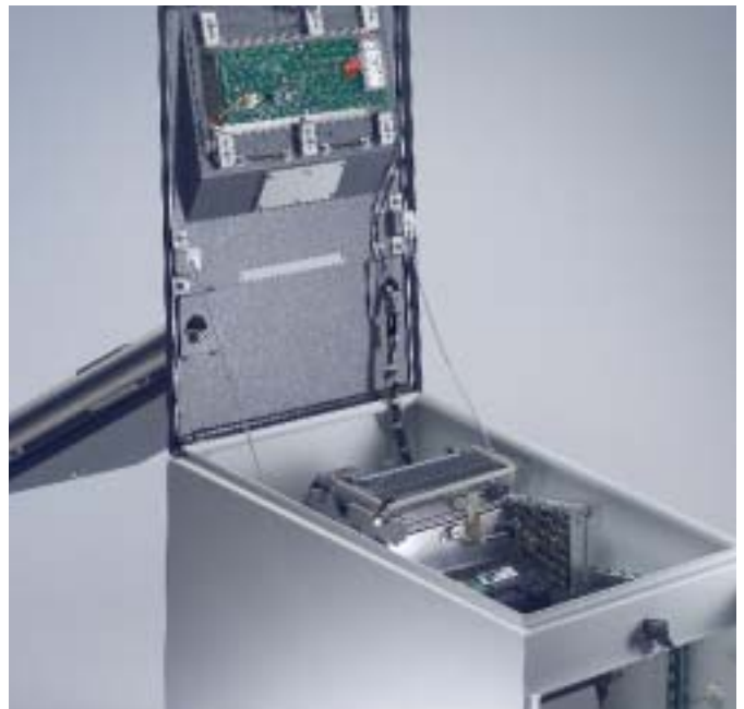
Exemple d'une solution sur mesure destinée à un environnement industriel, avec imprimante thermique et bac 4000 feuilles.
