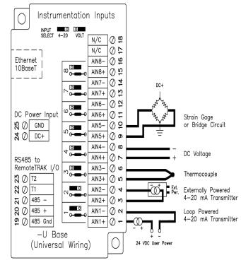
Connect Up to 8 4—20 mA, Voltage or Thermocouple Inputs
