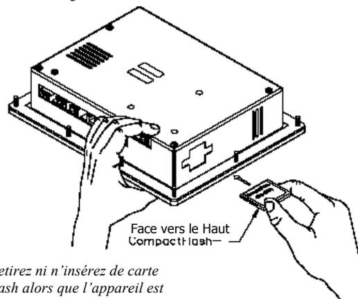
*Nota : Ne retirez ni n'insérez de carte CompactFlash alors que l'appareil est sous tension. Cf. paragraphe "LEDs de facade"*
