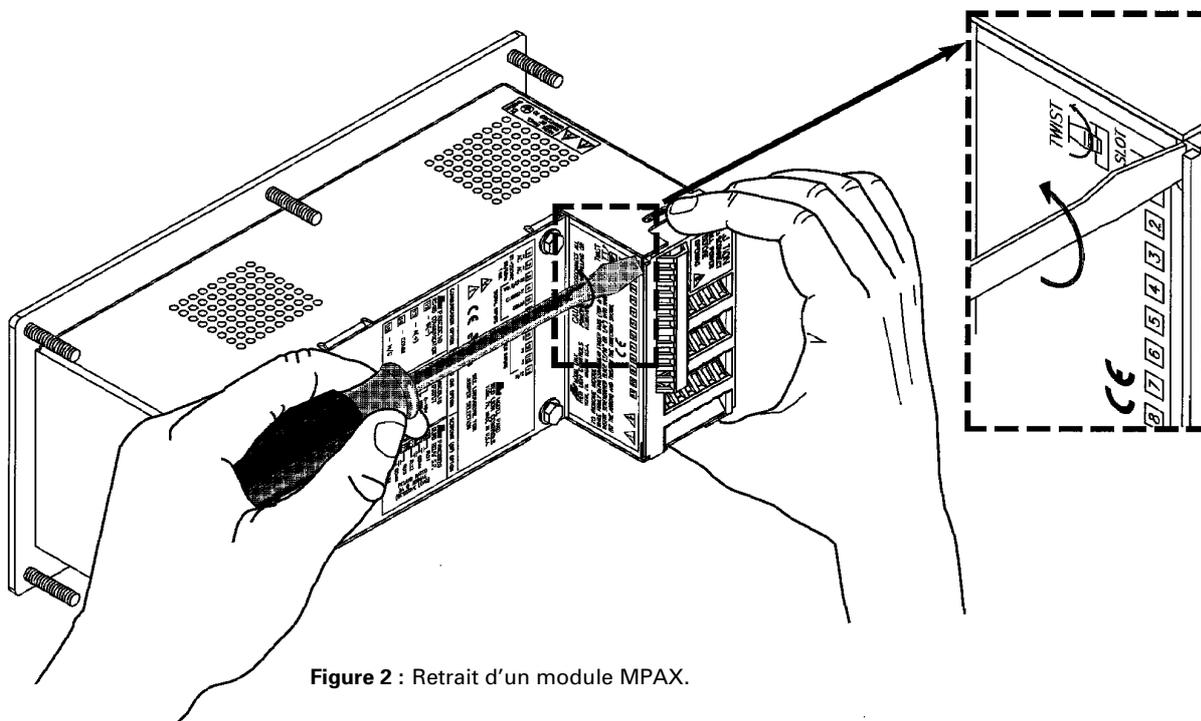
Figure 2 : Retrait d'un module MPAX.
