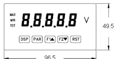
Nota : Pour permettre l'installation des clips de fixation, la distance disponible, en largeur, à l'arrière du panneau de fixation doit être de 127 mm (sur une hauteur de 54 mm)
