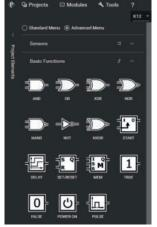
blocs fonctionnels représentent toutes les fonctions logiques nécessaires pour élaborer le flux de données entre les capteurs et les sorties. Depuis le panneau des blocs fonctionnels, il est possible d'en sélectionner un avec la souris et de le faire glisser dans la zone dédiée du Desktop.
