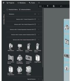
La zone des capteurs indique les types de dispositifs externes qui peuvent être connectés aux bornes du module, ainsi que tous les paramètres nécessaires pour les définir.
