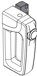
Montage vertical avec capteur à droite
