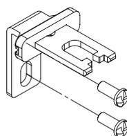
Conformément à la norme ISO 14119, l'actionneur doit être fixé au châssis du protecteur de façon inamovible. Des vis de sécurité à tête bombée, avec une empreinte one-way, sont disponibles à cet effet. Avec ce type de vis, les actionneurs ne peuvent être ni retirés ni forcés au moyen d'outils classiques. Voir Accessoires page 419.
