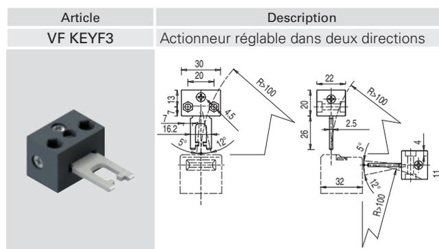
Actionneur pouvant osciller dans les quatre directions pour faciliter l'introduction dans l'interrupteur quand le protecteur n'est pas aligné.
