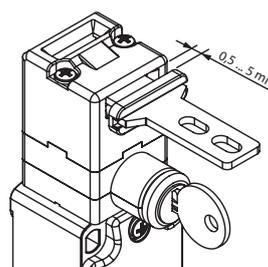
Cet interrupteur dispose d'un grand jeu de l'actionneur dans la tête. De cette manière, le protecteur peut bouger dans le sens d'insertion (4,5 mm) sans provoquer d'arrêt non souhaité de la machine. Tous les actionneurs présentent ce jeu qui permet de garantir la fiabilité optimale du dispositif.
