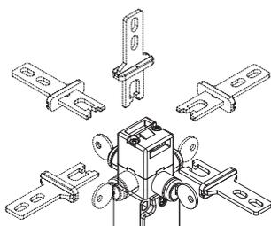
La tête peut être rapidement positionnée sur les quatre côtés en agissant sur les deux vis de fixation.
