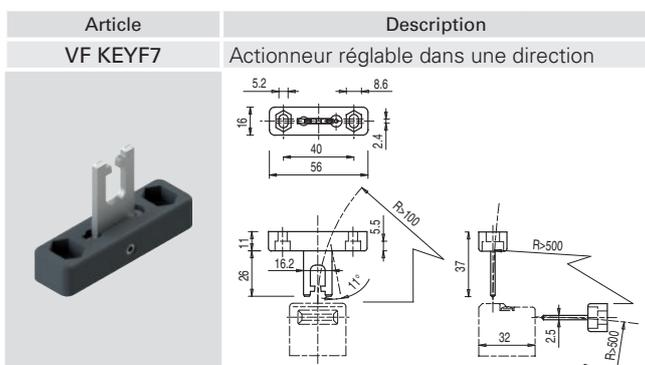
Actionneur avec possibilité de réglage dans une direction pour protecteurs de petites dimensions.
